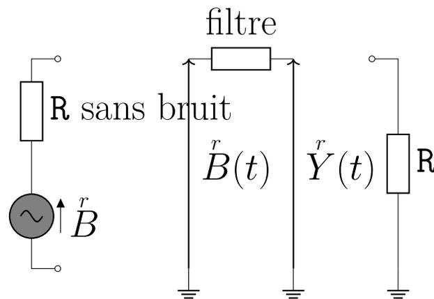
Figure 14.1: Modélisation du bruit thermique par un bruit en tension  $\overset{r}{B}$  en série avec une résistance sans bruit amplifié d'un facteur  $a$  par un filtre à bande limitée  $\Delta B$ .
