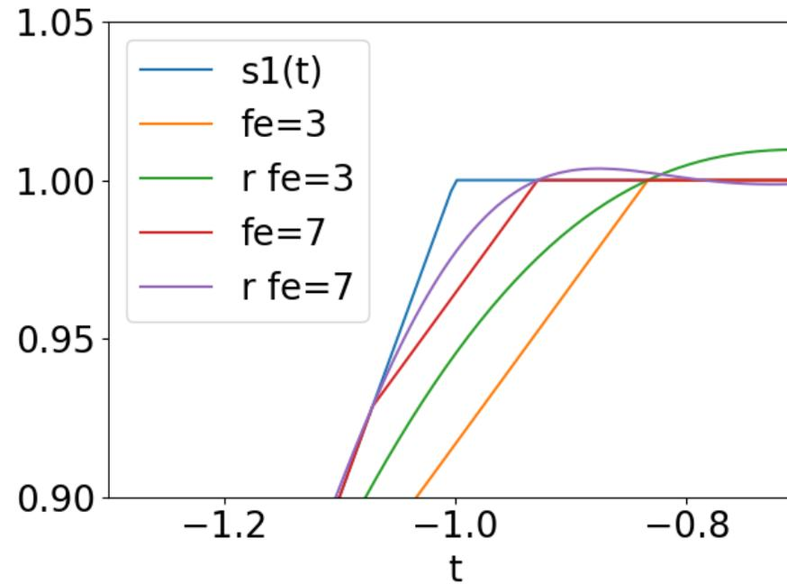
Figure 11.3: Signal étudié  $s_1(t)$  et deux échantillonnages
