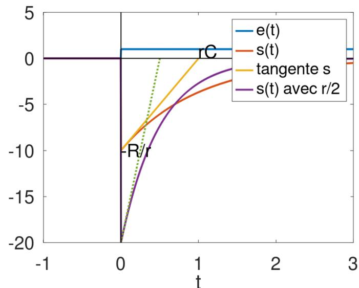
Figure 5.1: À gauche : montage dérivateur avec une résistance  $r$  faible et inconnue. À droite réponse dépendant de la résistance  $r$  et illustrée avec deux valeurs de  $r$ .
