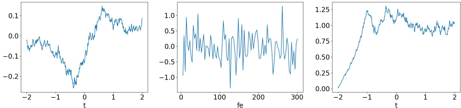
Figure 14.3: À gauche : trajectoire moyenne obtenue en moyennant 100 trajectoires de  $Y_n^f$  en fonction du temps pour  $f_e = 100\text{Hz}$ . Au milieu : Valeur moyenne de chaque trajectoire  $Y_n^f$  en fonction de  $f_e$ . À droite : trajectoire moyenne en moyennant le carré de 100 trajectoires de  $Y_n^f$  en fonction du temps pour  $f_e = 100\text{Hz}$ .
