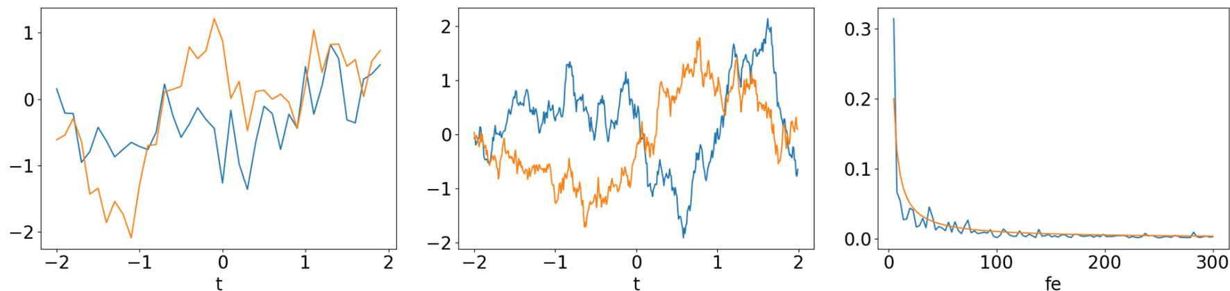
Figure 14.2: Sortie d'un filtre moyenneur en supposant que le signal est échantillonné à 10Hz à gauche et à 100Hz au milieu. À droite : Variance de  $Y_n^r$  en fonction de  $f_e$ .
