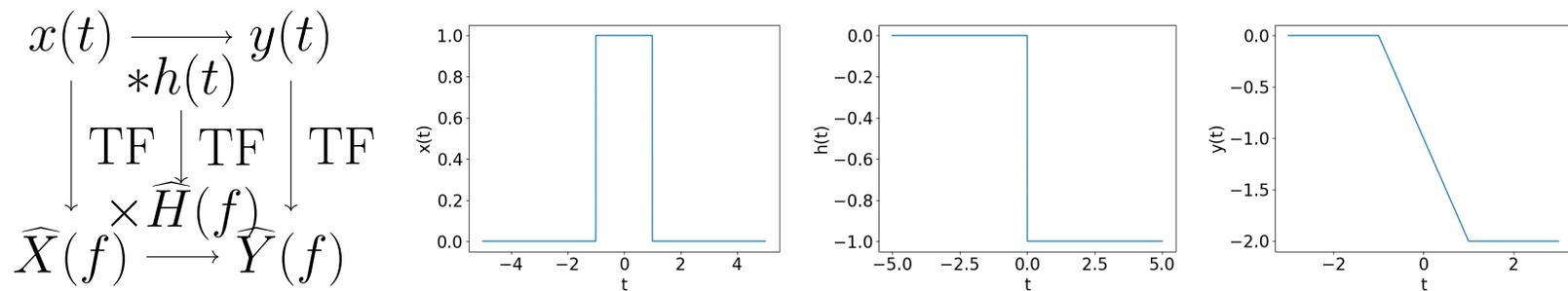
Figure 7.2: À gauche : diagramme filtre et réponse fréquentielle. À droite : simulation d'un filtre déjà illustré sur la figure 2.3 en utilisant la flèche du milieu dans le sens inverse l'algorithme 9.
