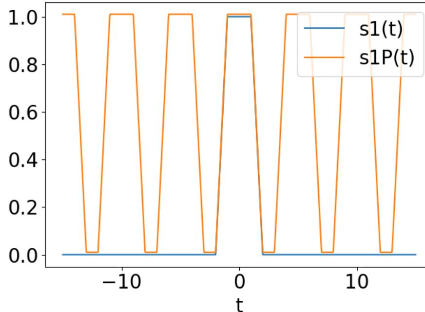
Figure 9.5: Signal  $s_1(t)$  en bleu périodisé en  $s_1^P(t)$  en répétant le motif défini sur  $[-\frac{5}{2}, \frac{5}{2}]$ .
