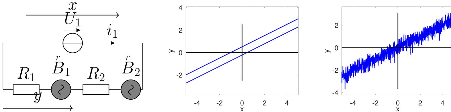
Figure 13.1: À gauche : diviseur de tension. Au milieu : graphe de  $y$  en fonction de  $x$  pour deux réalisations différentes. À droite : graphe de  $y$  en fonction de  $x$  lorsqu'on teste successivement pour chaque valeur de  $x$  la valeur de  $y$ .
