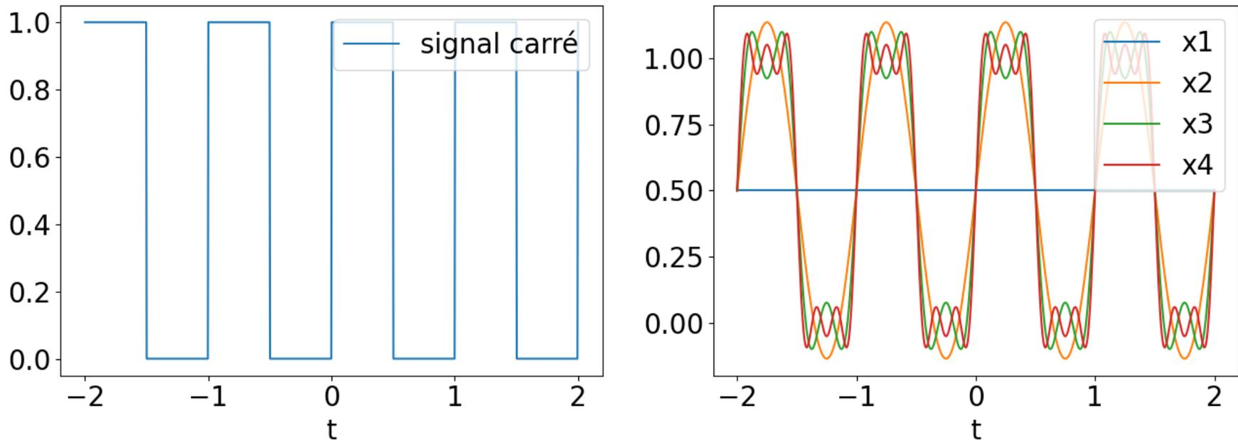
Figure 9.4: À gauche le signal carré périodique d'origine  $x(t)$  et à droite sa reconstruction au moyen de sinusoides.
